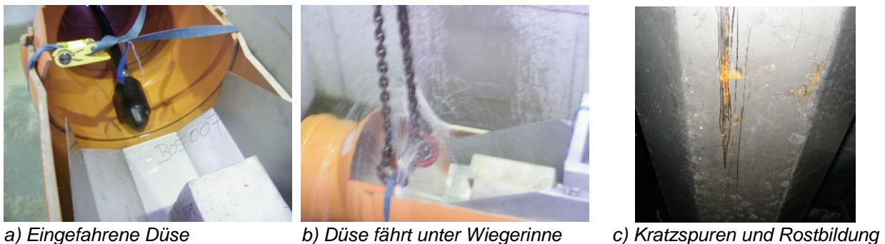
Bild 38 Anprallprüfung mit Kanalreinigungsdüse
