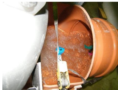
a) Hygieneartikel b) Hygieneartikel c) Steinzeugscherbe, Bohrkern Bild 65 Prüfung der Verlegebeseitigung der Turbo-Wirbeldrossel durch Zugabe von Hygieneartikeln und Störstoffen
