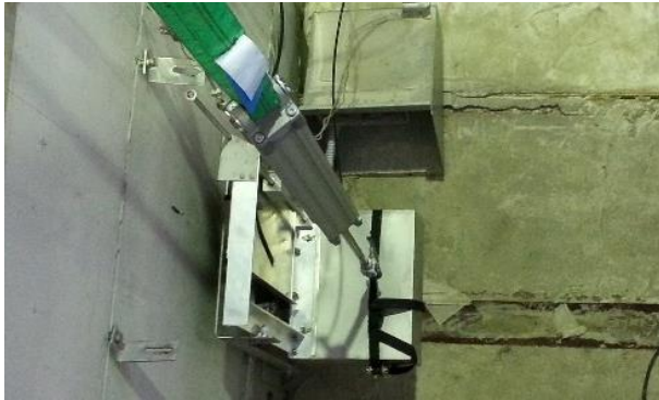
Bild 74 Versuchsaufbau für die Betriebssimulation „mechanische Belastung“
