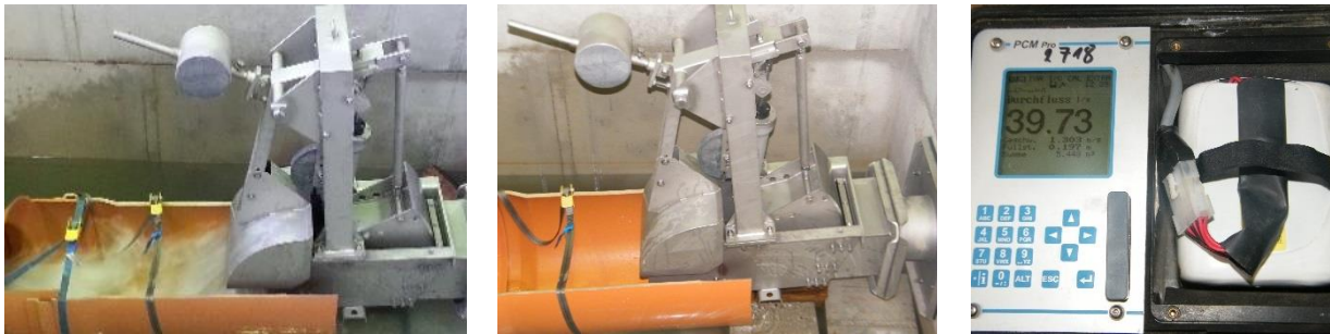
a) Ungedrosselter Durchfluss (40l/s) b) Unbewegtes Strahlschild c) Kontrolle der Messwerte Bild 49 Versuchsdurchführung mit feststehendem Segmentschütz (Betriebstauglichkeit I, Ifd. Nr. 8 des Prüfprogramms)
