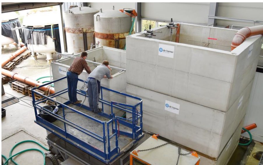
Bild 7 Versuchsanlage mit Regenbecken, Drosselbauwerk und Vorlagebehältern
