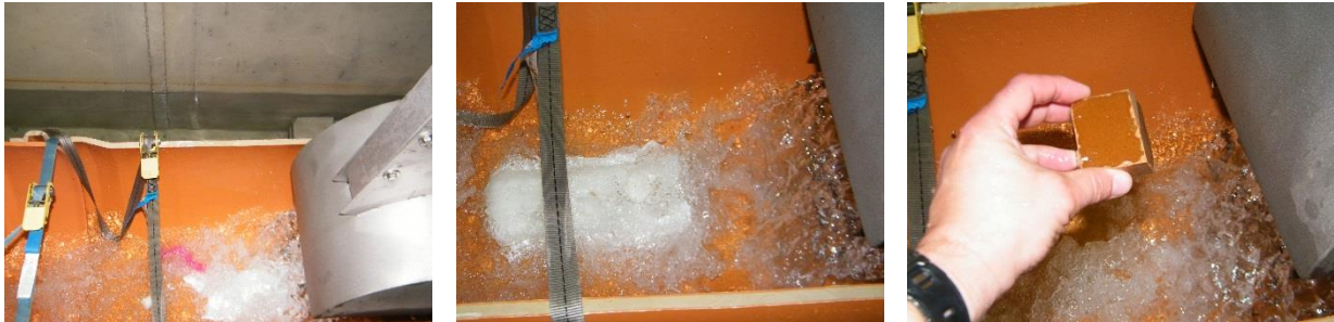
a) Durchfluss von Hygieneartikeln b) Durchfluss einer Windel c) Durchfluss einer Scherbe Bild 53 Prüfung der Verlegebeseitigung der Strahl-Drossel durch Zugabe von Hygieneartikeln und Störstoffen
