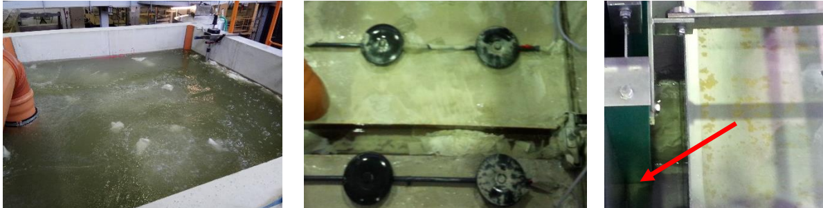
a) Voll eingestautes Regenbecken b) Ablagerungen nach dem Versuch c) Durchgang Tücher (Pfeil) Bild 20 SüwVO II-Prüfung mit synthetischem Schmutzwasser
