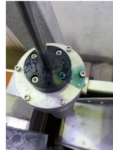
c) Austritt von Dämpferflüssigkeit
