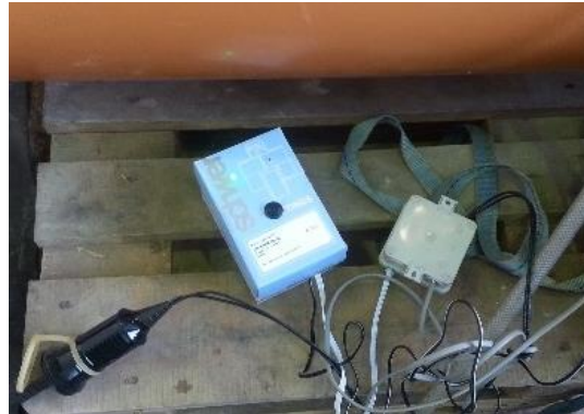
b) Steuereinheit für die Ein-/Ausschaltphasen der Maschine
