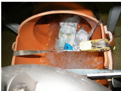
a) Hygieneartikel b) Hygieneartikel c) Steinzeugscherbe, Bohrkern Bild 65 Prüfung der Verlegebeseitigung der Turbo-Wirbeldrossel durch Zugabe von Hygieneartikeln und Störstoffen
