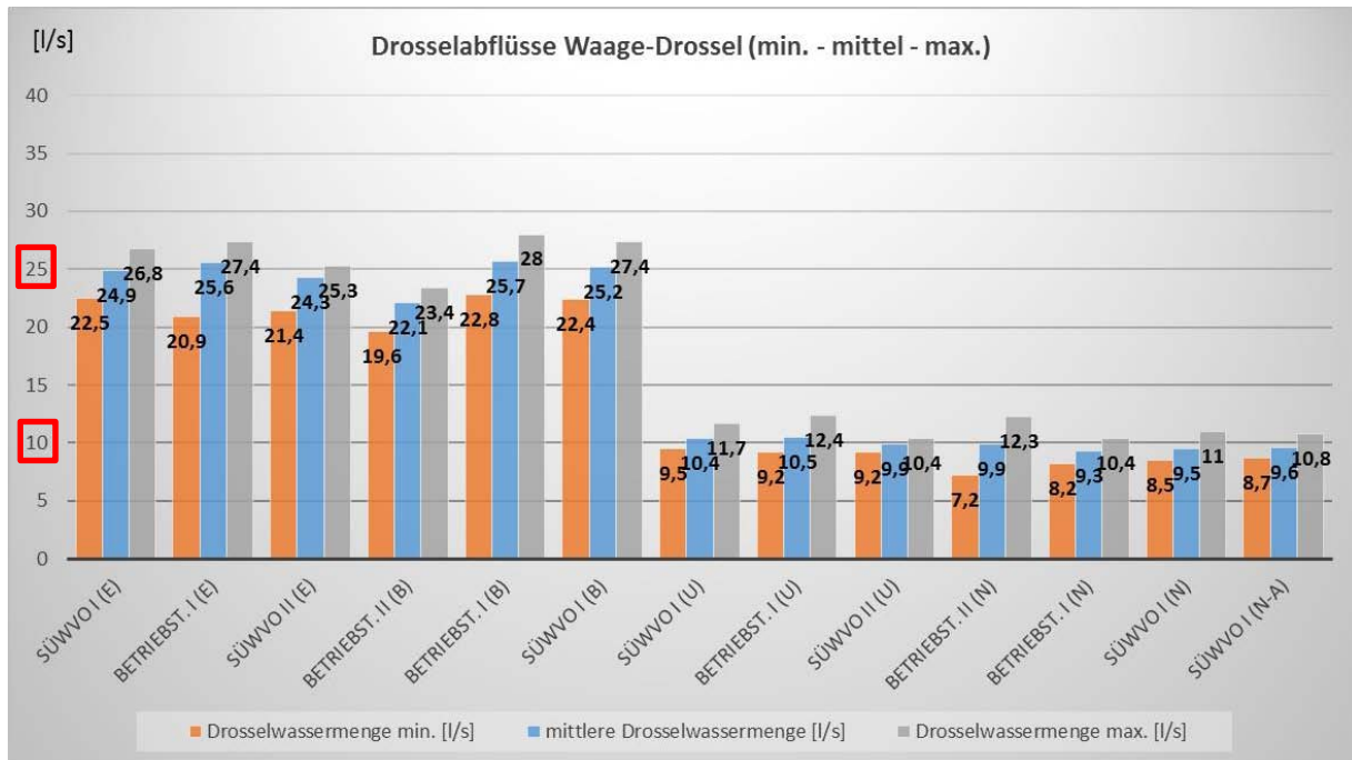
Bild 40 Mittlere, minimale und maximale Drosselabflüsse der Waage-Drossel nach Prüfprogramm mit Sollabflüssen
