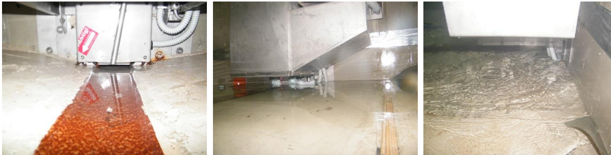
a) Zulauf zum Drosselorgan b) Verlegung durch 3 Windeln c) Wasseranstieg im Becken Bild 77 Prüfung der Verlegebeseitigung, Beispiel mit Windeln
