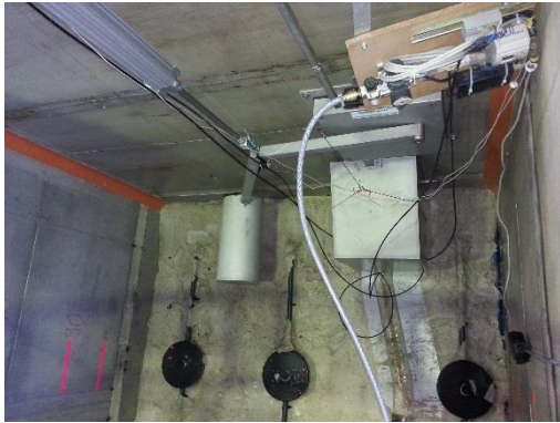
Bild 87 Versuchsaufbau für die Betriebssimulation „mechanische Belastung“
