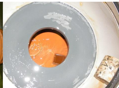
a) Hygieneartikel b) Hygieneartikel c) Steinzeugscherbe, Bohrkern Bild 65 Prüfung der Verlegebeseitigung der Turbo-Wirbeldrossel durch Zugabe von Hygieneartikeln und Störstoffen
