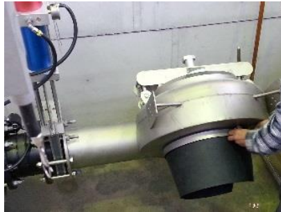
a) Hydraulikzylinder, Schieber b) Drosselorgan mit Auslauf Bild 58 Baugruppen/-teile der Turbo-Wirbeldrossel
