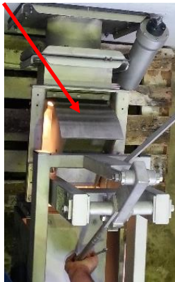
a) Segmentschütz (roter Pfeil)
