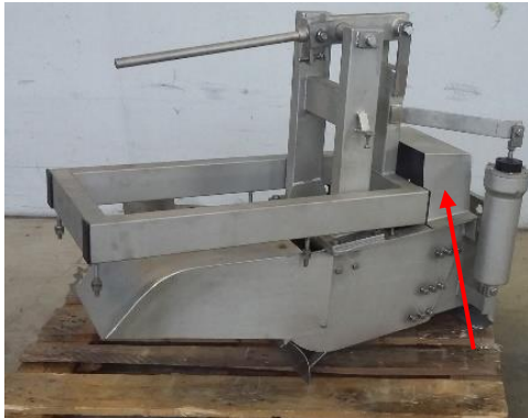
a) Drosselorgan nach Anlieferung
