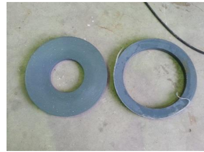
a) Herausschneiden der Blende b) Aufbringen des Klebers c) Vergleich der Querschnitte Bild 64 Wesentliche Arbeitsschritte für die Umstellung der Drosselwassermenge
