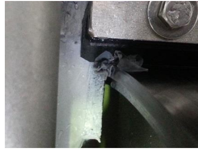
c) Schwergängigkeit durch Störkörper
