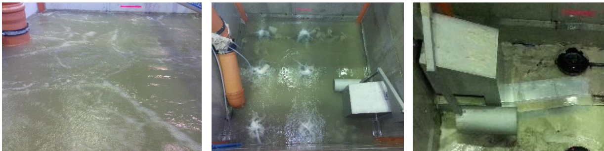
a) Voll eingestautes Regenbecken b) Füllstand bei Versuchsende c) Ablagerungen
