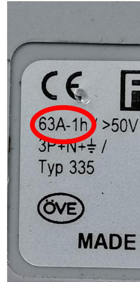
Gemäß DIN VDE 0100-551 Bbl 1 :2019-06 müssen Notstromeinspeisungen mit mobilen Stromerzeugern durch **elektrotechnische Laien** mittels **1 Uhr codierten Steckvorrichtungen** erfolgen. Hierfür muss gebäudeseitig ein Gerätestecker sowie die Anschlussleitung (Stecker und Kupplung) zwischen Stromerzeuger und Einspeisung mit 1h Stellung verwendet werden.
