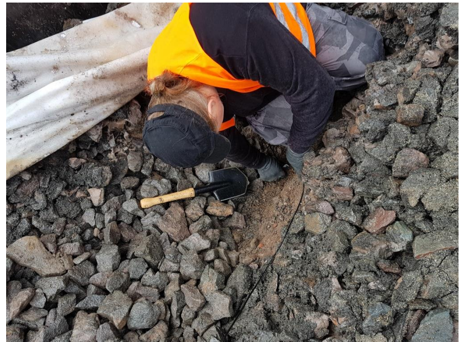
Abb. 22 u. 23: Einbau Messtechnik Monitoring in 2 Tiefenlagen (Messung Temperatur u. Bodenfeuchte), Ruhr-Uni-Bochum
