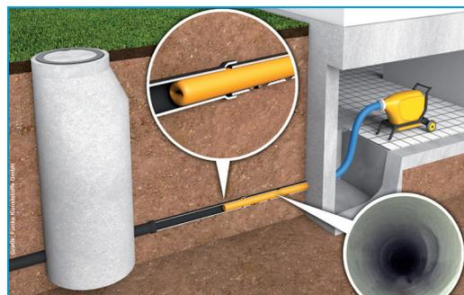
Mögliche Sanierung von Wurzelschäden mit Schlauchliner
