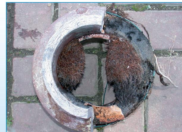
Wurzeleinwuchs in eine Abwasserleitung, ausgebautes Rohrstück
